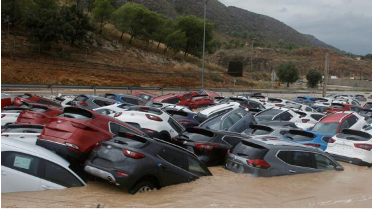
Figura 3. Vehículos movilizados de un aparcamiento por una avenida torrencial y depositados con disposición imbricada denotando que el sentido de la corriente de la avenida fue de derecha a izquierda según la foto. Fuente: Inundación en las proximidades de Orihuela (Alicante) en septiembre de 2019. ABC.
